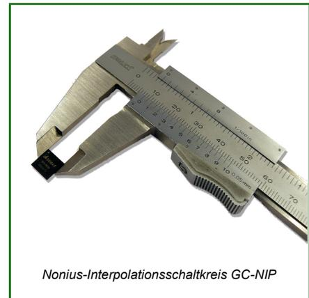
Der zweikanalige Noniusinterpolationsschaltkreis *GC-NIP* dient der Auflösungserhöhung für absolute Weg- und Winkelmesssysteme mit 2 sinusförmigen, um 90° phasenverschobenen Ausgangssignalen (Noniusignalen) sowie der Berechnung der Absolutposition des Sensors aus den beiden Noniusignalen. Ein- oder zweikanalige inkrementale Weg- oder Winkelmesssysteme können ebenfalls an den *GC-NIP* angeschlossen werden.
