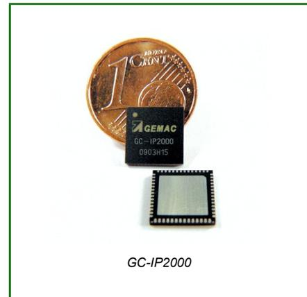
Der Interpolationsschaltkreis GC-IP2000 dient zur Auflösungserhöhung für inkrementale Weg- und Winkelmesssysteme mit sinusförmigen, um 90° phasenverschobenen Ausgangssignalen. Der IC unterteilt die Signalperiode bis zu 2048-fach.
